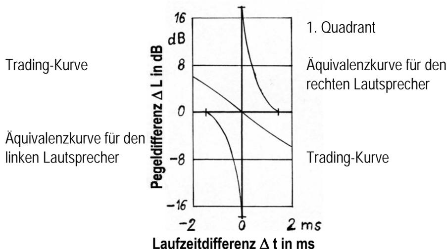
Hier folgt extra im gleichen Maßstab die **heutige Kurve**, die angibt, welche Laufzeitdifferenz mit welcher gleichsinnigen Pegeldifferenz genau die 100%-Hörereignisrichtung aus der Richtung eines Lautspecher ergibt.
