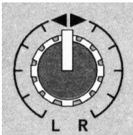
2. Dieses ist die Panpot-Beschriftung beim Mackie 1202-VLZ Mixer. Oben ist die Richtung für das Center gezeigt und dann sieht man L und R. Was sollen die Markierungsstriche anzeigen, die zwischen L und C bzw. R und Center liegen? Man sieht je einen Strich z. B. bei 1 Uhr, 2 Uhr, 3 Uhr und 4 Uhr.
