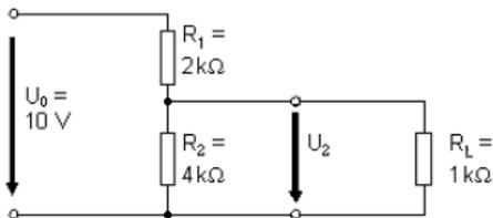
4. Wie groß ist am Ausgang dieses Spannungsteilers die Spannung  $U_2$ ? Und zwar:
