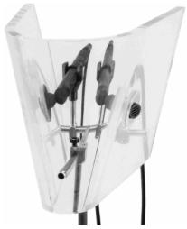
Clara-Trennkörpermikrofon. Auf jeder Seite des reflektierenden Acrylkörpers ist ein freifeldentzerrtes Druckmikrofon eingesetzt. Mikrofonbasis ist der Ohrabstand - nach Prof. Johann Hinrich Peters 1985
