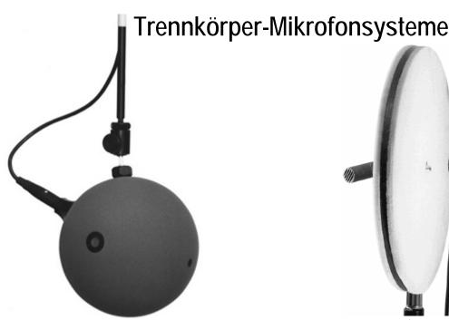
Kugelflächenmikrofon (Schoeps KFM 6) Zwei diffusfeld-entzerrte Druckmikrofone, bündig auf den gegenüberliegenden Seiten einer schallharten Kugel mit einem Durchmesser von 20 cm eingelassen sind.
