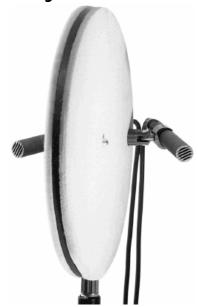
Jecklin-Scheibe (OSS = Optimales Stereo-System) Diffusfeld-entzerrte Druckmikrofone, die auf beiden Seiten einer gedämpften Scheibe von 30 cm Durchmesser angebracht sind, Mikrofonbasis 16,5 ncm. Dieses ist die veraltete historische Scheibe.
