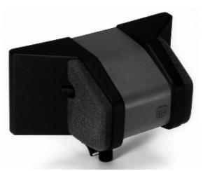
SASS-"Stereomikrofon" (Crown) Zwei Grenzflächen-Druckmikrofone mit 17 cm Mikrofonbasis auf einem speziellen absorbierend-reflektierenden Trennkörper
