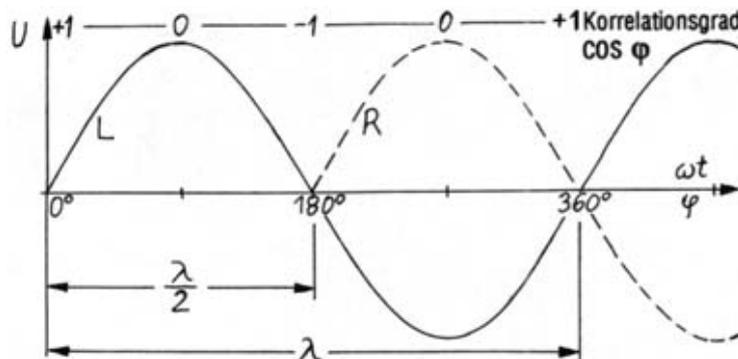
Einfluss der Wellenlänge  $\lambda$  auf die Phasendifferenz  $\Delta \varphi$  der Signale zwischen den AB-Raummikrofonen:
