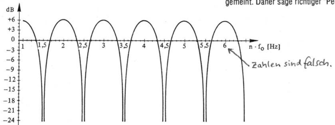
Abb. 5/15. Kammfilterkurve.
