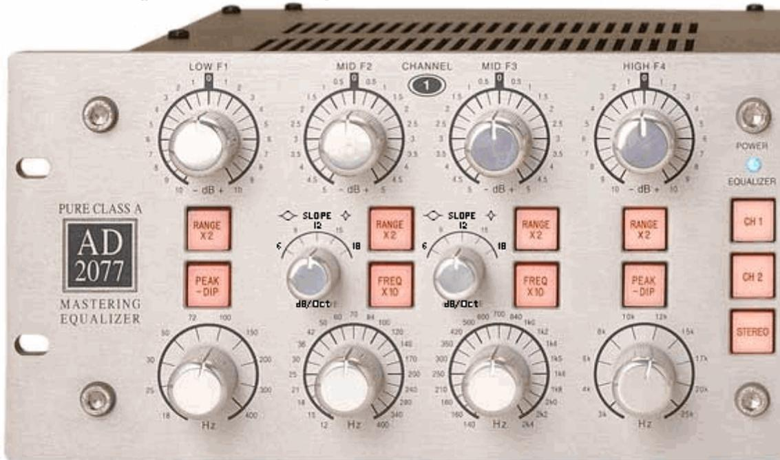
Mastering-Equalizer mit falscher Angabe der Filtereinstellung als "Slope in dB/octave" als  $Q$  factor (width). Es gibt hier 5 Positionen 6, 9, 12, 15, 18 dB per octave. Die Zahl 6 zeigt eine breite und 18 eine schmale Kurve. Beim Avalon EQ AD 2077 wird bei "Boost und Cut" die Größe in dB/oct angegeben. Das ist unverständlich, weil es beim Anheben oder Absenken (Gain) der Center-Frequenz keinen konstanten dB/Okt.-Wert geben kann.
