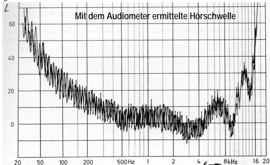
Man erkennt, dass die Toleranzgrenze von "gerade nicht mehr hörbar" und "gerade so hörbar" bei mehr als  $\pm 5$  dB liegt.
