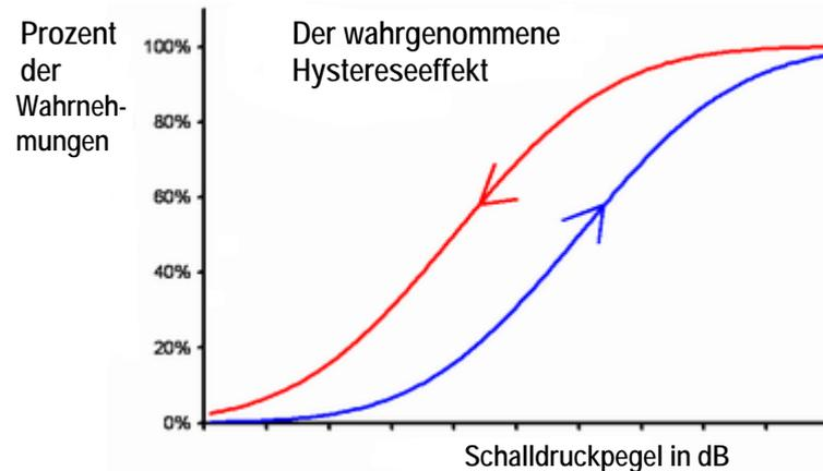
Absteigende Durchläufe (rote Linie) ergeben eine "bessere", also eine tiefer liegende Hörschwelle als aufsteigende Durchläufe (blaue Linie).
