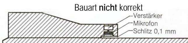
Bauart nicht korrekt Pressure Zone Microphone PZM = Warenzeichen der Firma Crown. Patentrechtlich geschützt.
