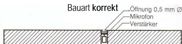
Bauart korrekt Grenzflächenmikrofon (Boundary Layer Microphone) Kein Patentschutz – also frei.
